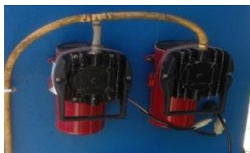
Figura 2: Bombas auxiliadas por motores e compressores de ar.
