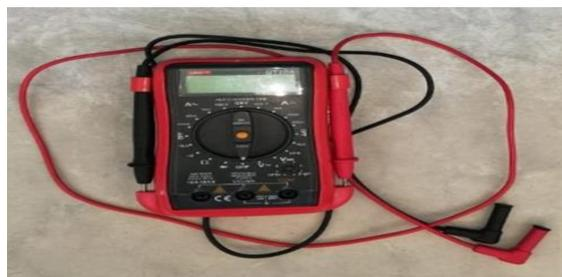
Figura 5: multímetro digital para medição da tensão, intensidade e a resistência.
