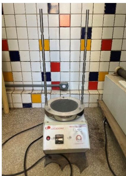
Figura 11 – Mesa agitadora e as peneiras
