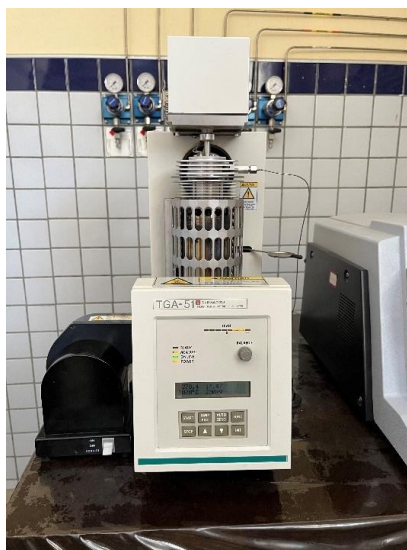
Figura 14 – Aparelho TGA-51H Shimadzu
