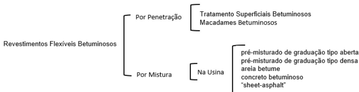
Figura 3: Classificação dos revestimentos flexíveis betuminosos.
