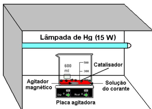
Figura 4 - Esquema do reator UV.
