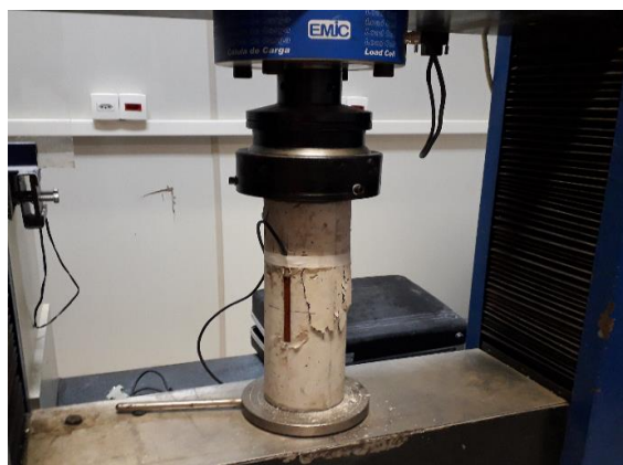
Figura 5: Vista do corpo de prova após a sua ruptura. Fonte: Arquivo pessoal.
