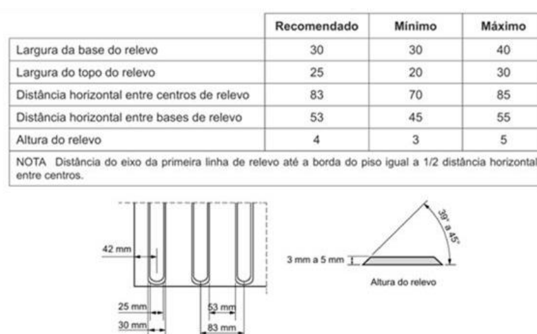
Figura 02. Dimensionamento dos relevos do piso tátil direcional.
