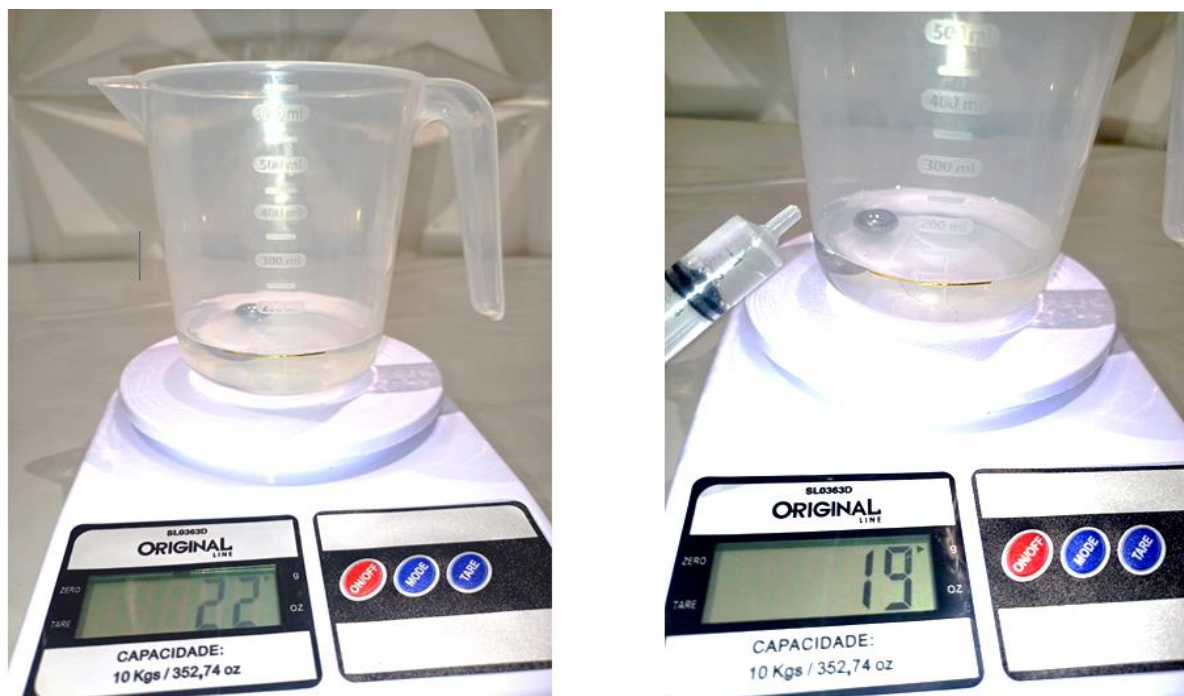
Figura 4 – Densidade da bola de aço
