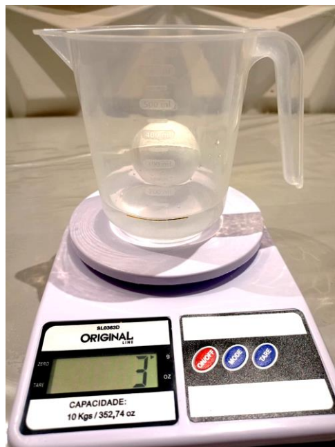
Figura 5 – Densidade da bola de isopor
