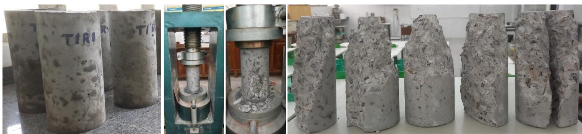
Figura 8 – Principais tipos de rupturas ocorridas nos corpos de prova padrão
