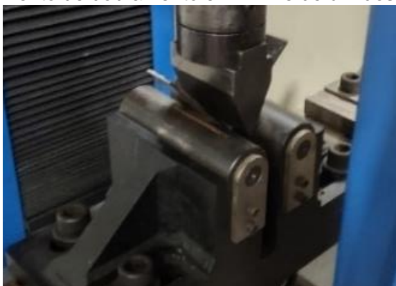
Figura 4: Experimento de dobramento em V livre de um dos corpos de prova.
