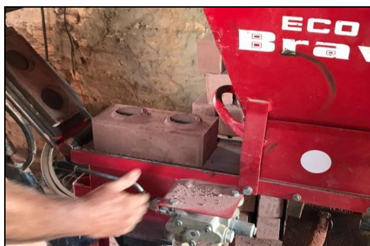
Figura 6 – Confeção dos tijolos de solo-cimento
