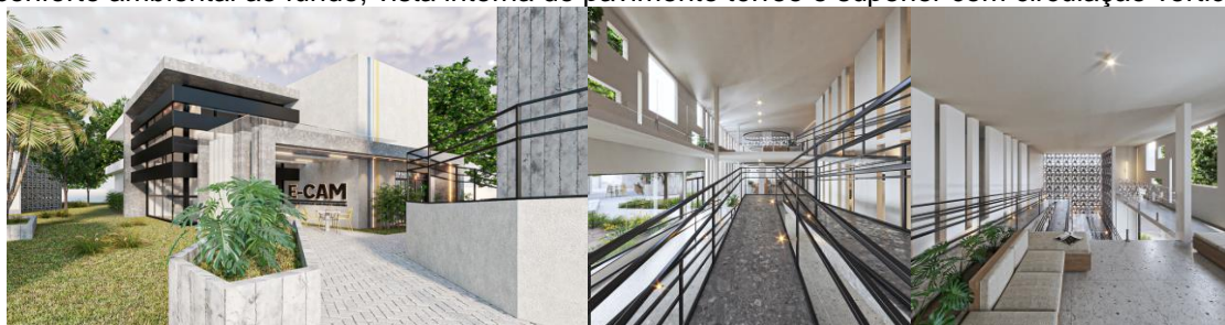
Figura 13. Espaço de Comunicação Audiovisual e Multimídia (E-CAM), solução com cobogós para conforto ambiental ao fundo, vista interna do pavimento térreo e superior com circulação vertical
