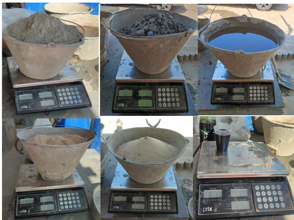
Figura 1 - Materiais utilizados na dosagem do concreto.
