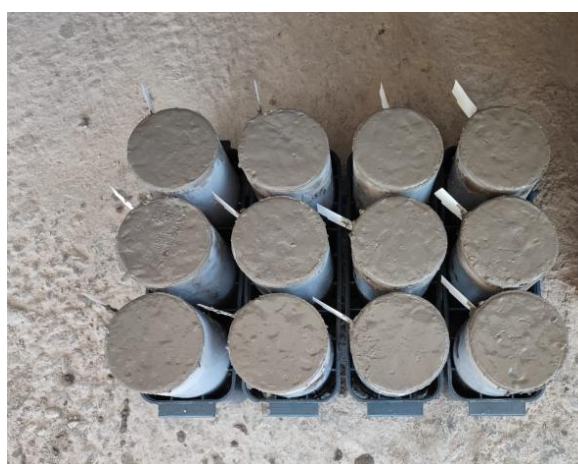
Figura 4 - moldagem dos corpos de prova
