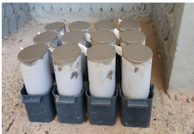
Figura 4 - moldagem dos corpos de prova
