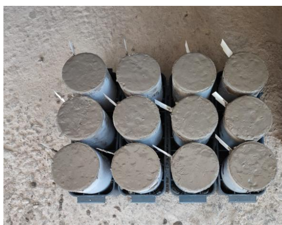
Figura 4 - moldagem dos corpos de prova
