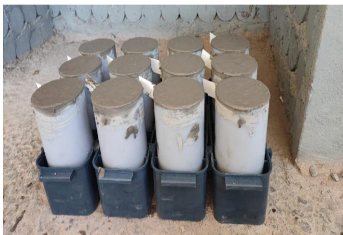
Figura 4 - moldagem dos corpos de prova
