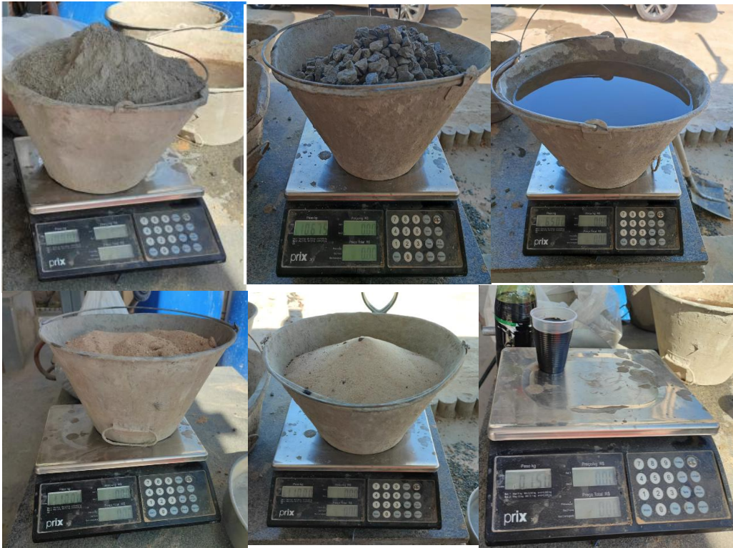
Figura 1 - Materiais utilizados na dosagem do concreto.
