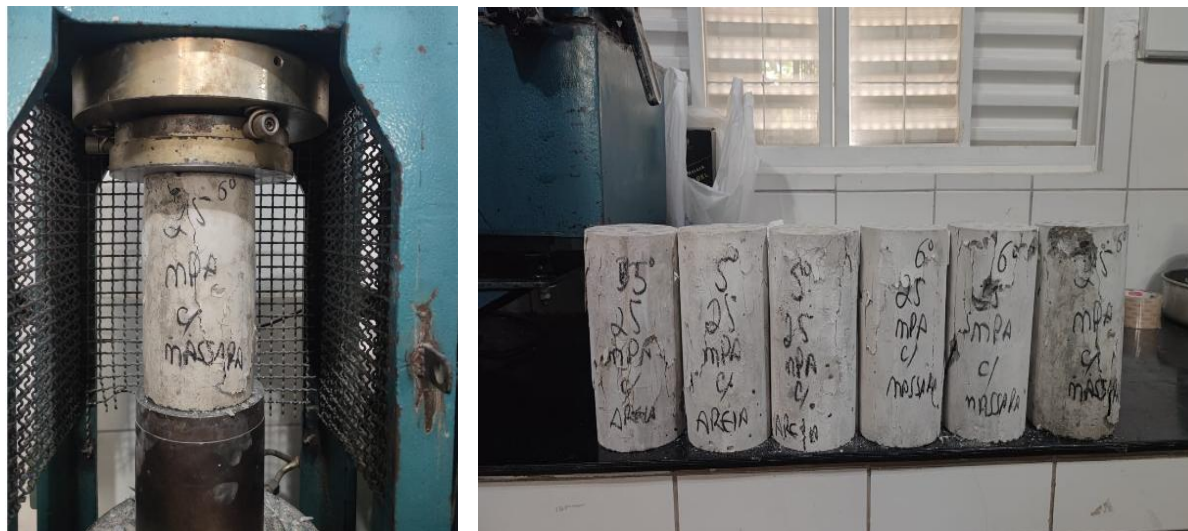
Figura 6- Rompimento do corpo de prova
