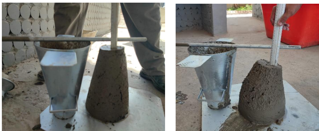
Figura 3 - slump test do concreto com areia e massará
