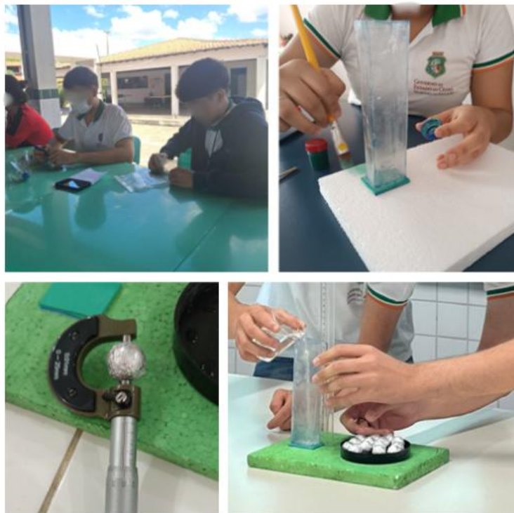
Figura 2 – Construção do modelo físico do recipiente com esferas
