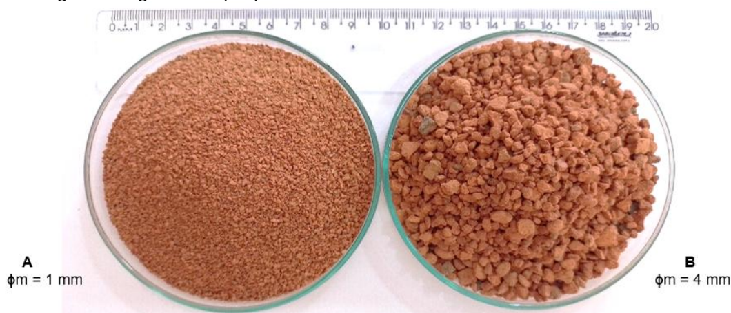
Figura 2 - Registro fotográfico de porção de chamote a 1mm e 4 mm.
