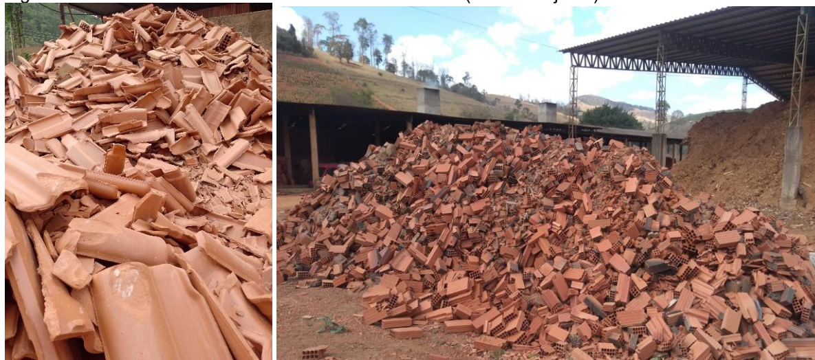
Figura 1 - Resíduos de Indústria de Cerâmica Vermelha (telhas e lajotas).
