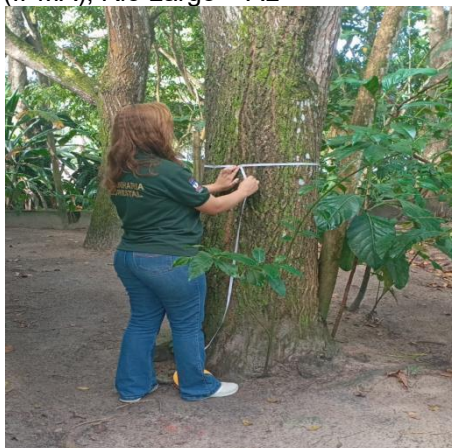
Figura 2 - Procedimento de medição do Circunferência à Altura do Peito (CAP) em espécime arbóreo no fragmento de Mata Atlântica (IPMA), Rio Largo – AL
